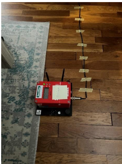
Figuur 3 – meetopstelling hinder slaapkamer
